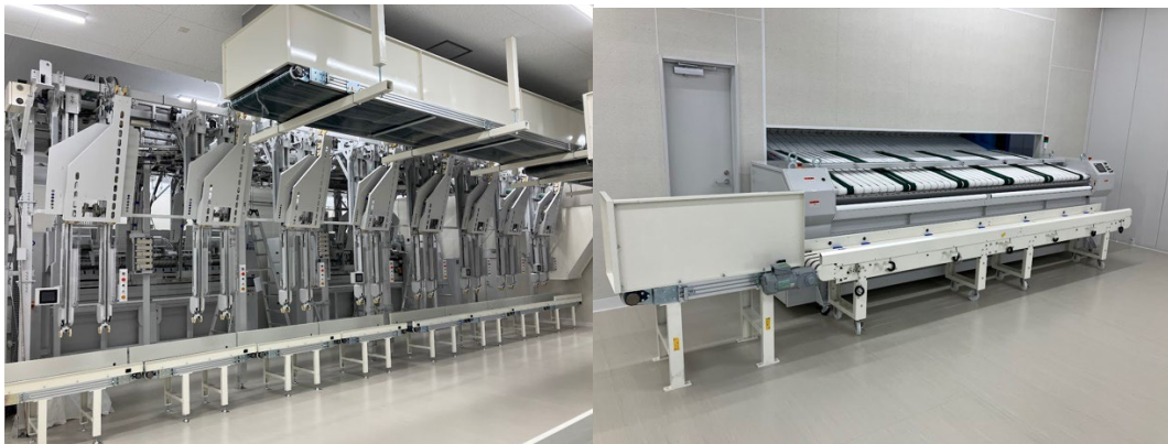
ハヤブサ（シーツ等仕上げ用自動投入機）
